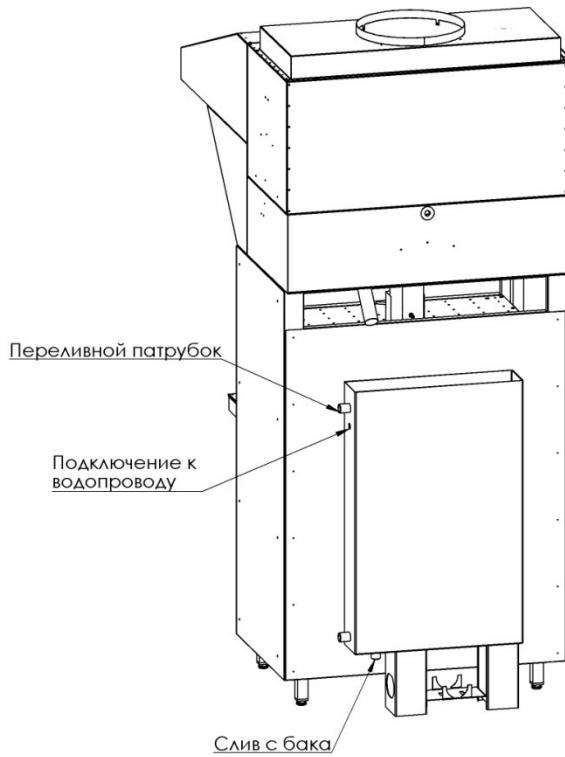
После проверки состояния упаковки, распаковать гриль-мангал и проверить комплектность в соответствии с таблицей 2. Далее установить искрогаситель. Перед установкой изделия не забудьте закрутить регулируемые опоры. Гриль-мангал разместить в хорошо проветриваемом помещении, под вытяжным зонтом.
